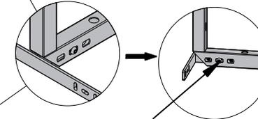
Отрегулируйте винт так, чтобы Т-образный соединитель дверной панели был расположен в центре основной рамы
