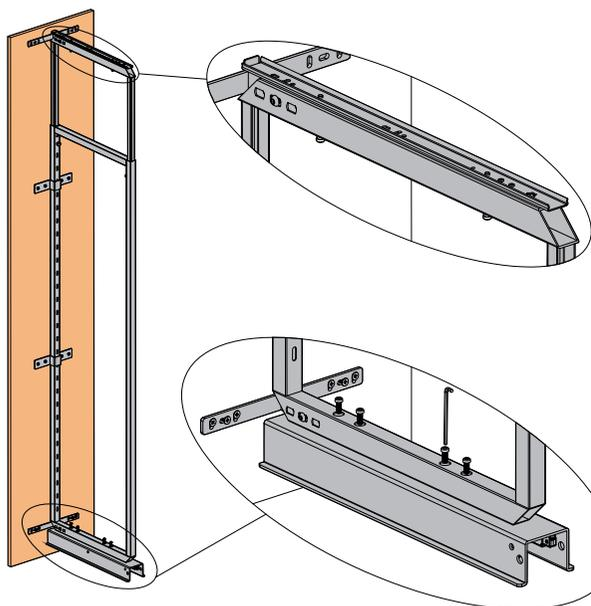
Вставьте верхнюю направляющую в соответствующее отверстие регулируемой рамы
