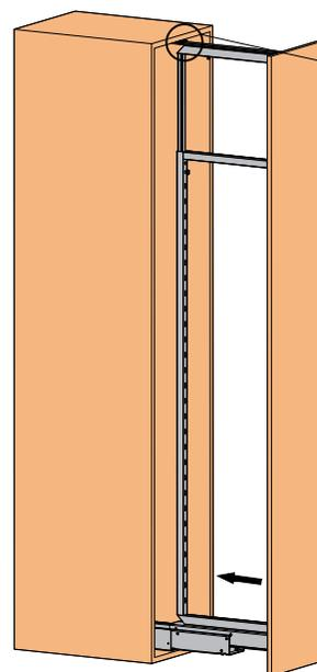
Вытяните среднюю часть нижней направляющей и удерживайте ее. Затем вставьте основную направляющую в шкаф. Когда будет слышен звук отскока пружины, это указывает на то, что направляющая установлена. Одновременно с этим вставьте верхнюю направляющую в предустановленную ответную часть.
