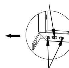
После завершения сборки с помощью T-образных соединительных винтов на фасаде, отрегулируйте его положение таким образом, чтобы она располагалась по центру шкафа.
