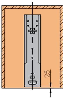
Зафиксируйте нижнюю часть направляющей с помощью саморезов ST4x16, как показано на схеме
