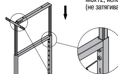
Вставьте Т-образный соединитель дверной панели в основную раму и зафиксируйте шестигранными болтами M6x18
