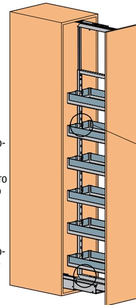
Навесьте корзины в соответствующие отверстия в основной раме с помощью крючков для корзин и отрегулируйте расстояние между ними
