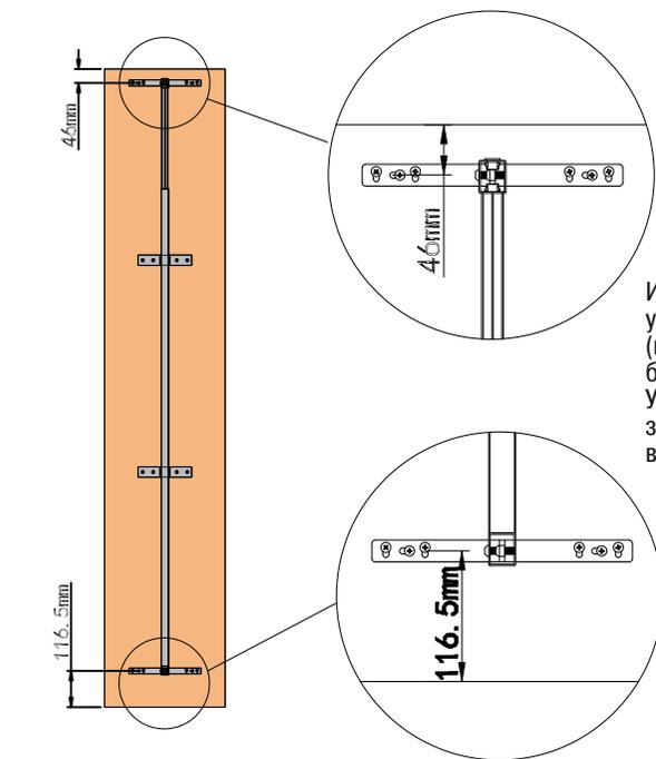
Используйте саморезы ST4x16 для установки основной рамы на фасад (примечание: основная рама должна быть установлена по центру). Установите крепления для фасада и затяните винты верхней регулировочной рамы.
